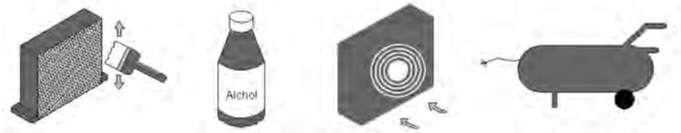
Figure 6 Nettoyage du condenseur
