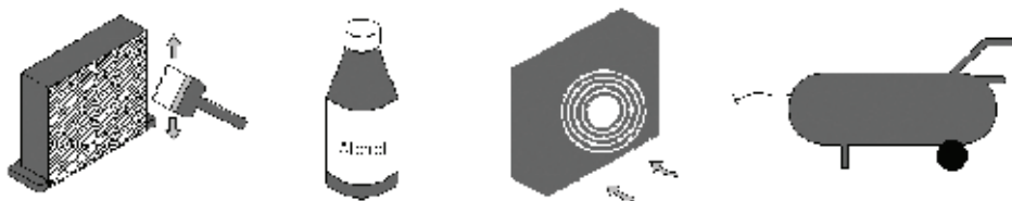
Figure 6 Nettoyage du condenseur
