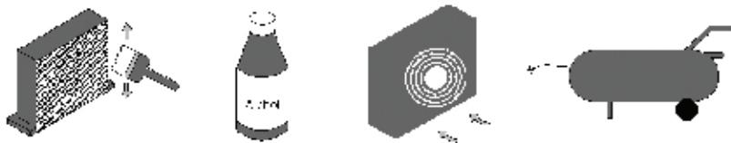
Figura 6 La limpieza del condensador
