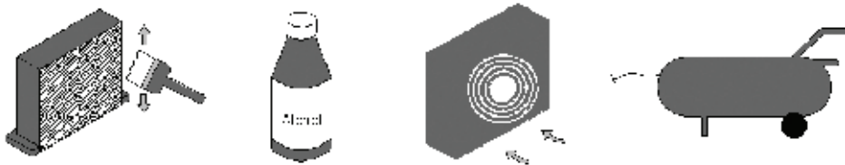
Bild 6 Reinigung des Kondensators
